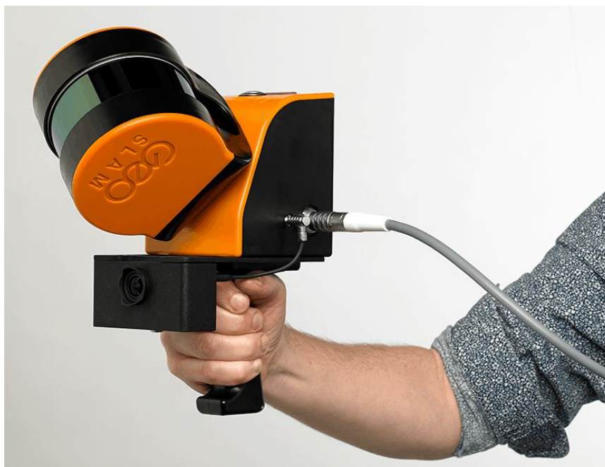
Рис. 1. Мобильный лидар на технологии SLAM (geoSLAM ZEB-HORIZON)
